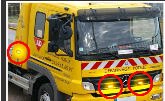
Speziell gerippte Linse für blaue, gelbe und rote Leuchten, zur Erfüllung der Europäischen Richtive UN R65.
