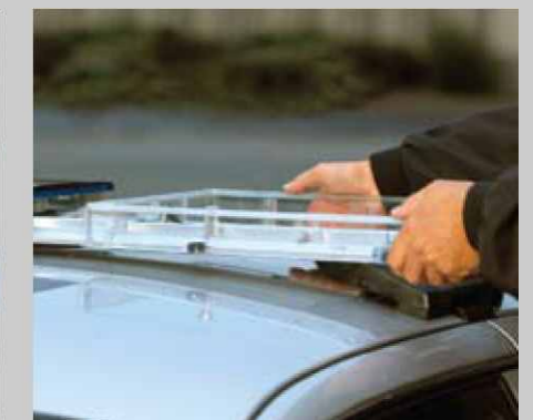
3 Die Basis zum Austausch seitlich abschieben.
